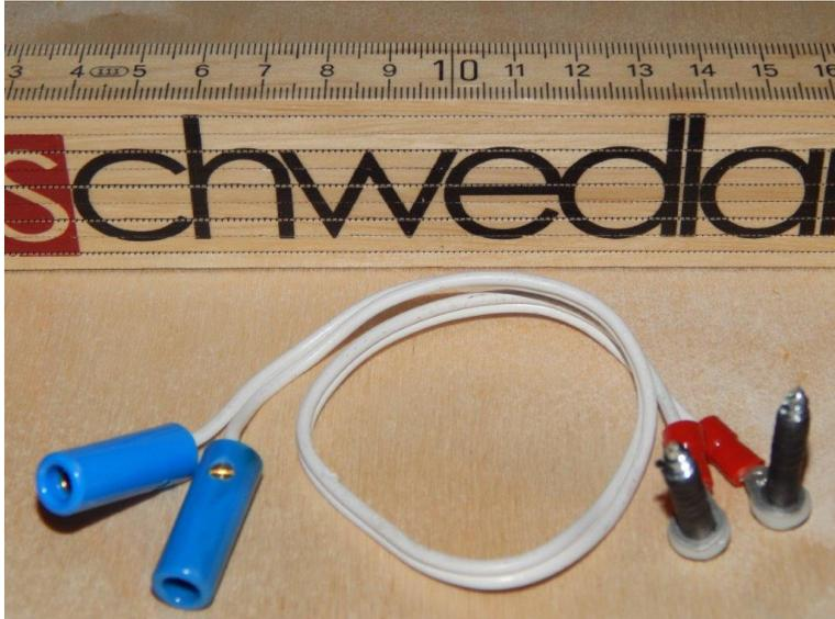
Bild 29: Elektroden mit Kabel und Stechhülsen
