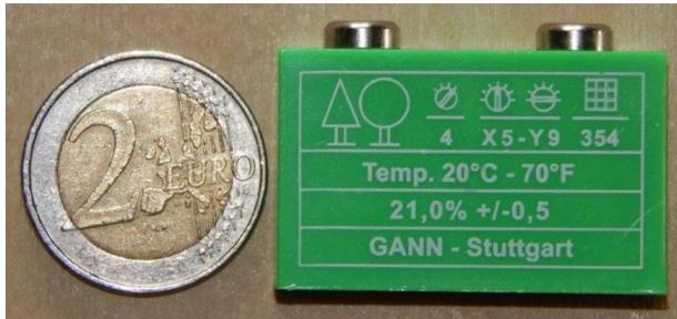
Bild 6: Prüfadapter für HMW Firma GANN mit Größenvergleich
